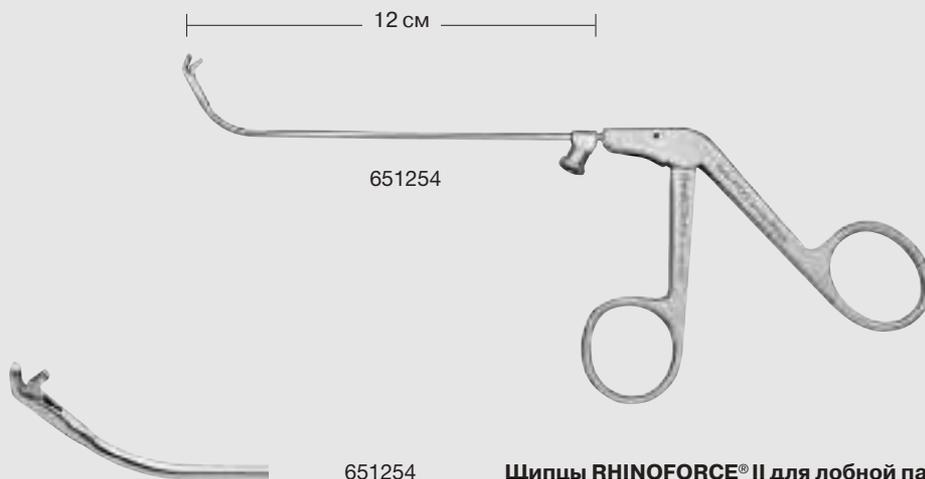
**Щипцы RHINOFORCE® II для лобной пазухи по KUHN,** режущие насквозь, бранши загнуты на 45°, особо тонкие и плоские для тканещающего разреза, стержень загнут вверх на 60°, ширина разреза 1,5 мм, открывающиеся назад, с разъемом для чистки, рабочая длина 12 см
